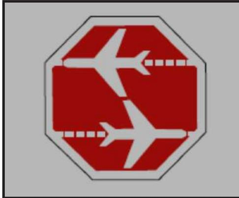
FIGURA E4.2 SEÑAL DE DETENCION ALTERNATIVA PARA PUNTOS DE ESPERA DE UNA VIA DE VEHICULOS QUE INTERSECTA UNA CALLE DE RODAJE
