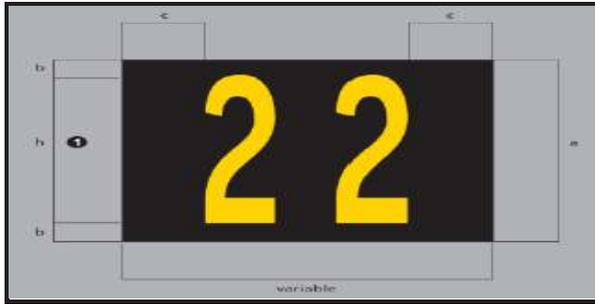
FIGURA E3.29 Señal de designación del puesto de estacionamiento
