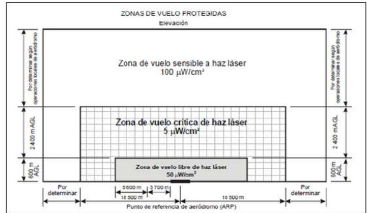
Figura F1.3. Zonas de vuelo protegidas indicando los niveles máximos de irradiación para rayos láser visibles
