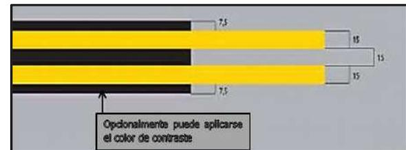
FIGURA E3.2 SEÑAL DE BORDE DE PLATAFORMA
