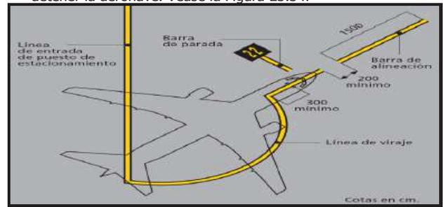
FIGURA E3.33 Señal de barra de alineación
