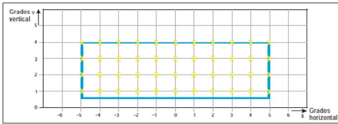
**Figura ADJB-21. Puntos de cuadrícula para el cálculo de la intensidad media de luces de eje de calle de rodaje y de luces de barra de parada**
