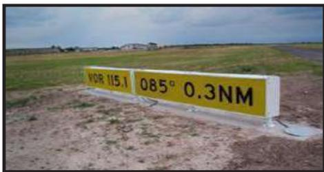
FIGURA D2.7 LETREROS DE PUNTO DE VERIFICACIÓN DEL VOR EN EL AERÓDROMO
