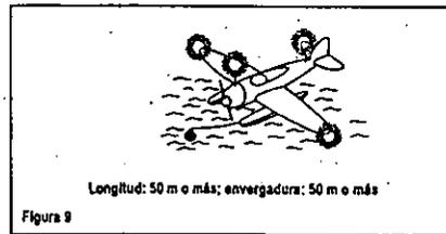
Cuando esté varado.- Debe ostentar las luces prescritas en la Figura 7 y además dos luces rojas fijas colocadas verticalmente una sobre la otra a una distancia no menor de un (1) m de manera que sean visibles desde todos los puntos del horizonte.
